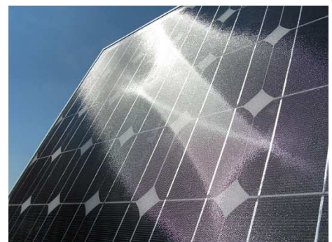
Geometrische Formen durch blickwinkelabhängige Maxima bei atypischer Reflexion an einem Photovoltaikmodul mit mikrostrukturierter Oberfläche
