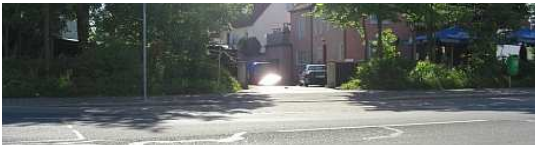
Reflex auf dem gleichen polykristallinen PV-Modul in ca. 50 m Entfernung, scheinbare Vergrößerung des Reflexes durch Bündelaufweitung
